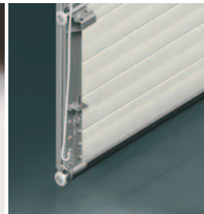
Schlaffseilsicherung an beiden Zugseilen sorgt für sofortigen Antriebsstop im Falle eines Seilbruchs
